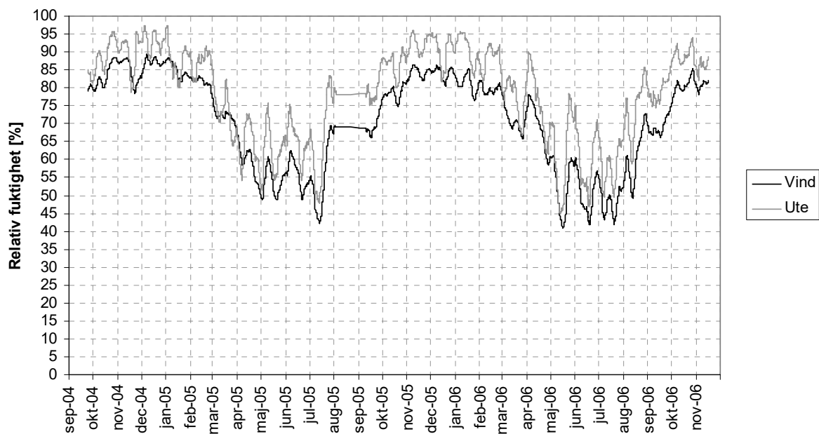
Figur 14. Glidande veckomedel-RF (%) i vinden med reducerad ventilation och diffusionsöppen underlagstäckning samt utomhus.
